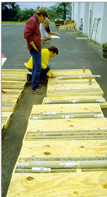
Использование кернов для проектирования зон отбора и установки пакеров (слева). Многоуровневый коллектор с индивидуальными насосами и датчиками давления для четырёх зон (справа).
