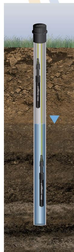
*LTC Levelogger 5 и Barologger 5 установленные в скважине на кабеле прямого считывания*
