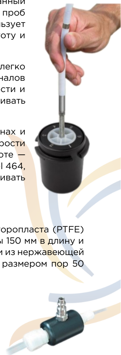
Коллектор насоса с быстросъёмным соединением для подачи воздуха и отбора проб через PTFE-трубку
