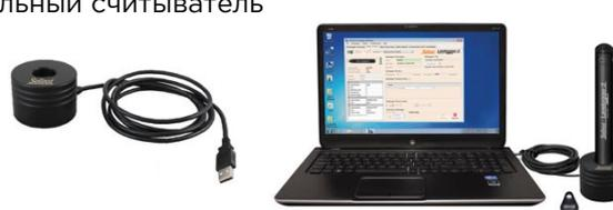
Для полевого развертывания используется трёхконтактный кабель, соединяющий регистратор с дождемером. Загрузка данных возможна в одном из трёх режимов: полная выгрузка, дозапись новых данных или очистка памяти. Полученная информация отображается в виде графиков и таблиц, легко экспортируется для последующего анализа.
