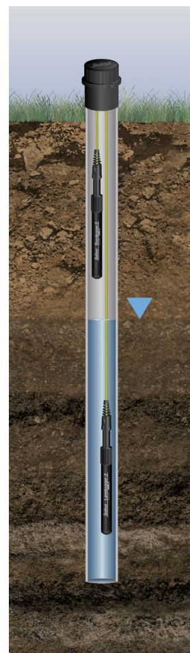
Levellogger 5 и Barologger 5 установленные в скважине на кабеле прямого считывания
