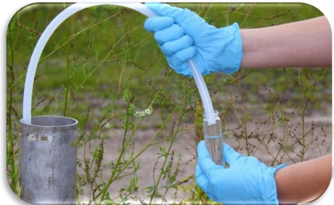
Чтобы начать откачку воды или отбор проб, наверните нижний клапан на трубу, затем опустите на желаемую глубину в колодец или скважину.
