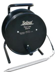
Гидрологическая рулетка **Модель 103** - это универсальный инструмент, который используется для спуска в скважины или водоёмы различных устройств, таких как пробоотборники, опускные пьезометры, насосы и другое оборудование.
