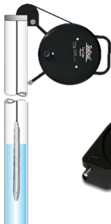
Обеспечивает повторяемость измерений, направляет ленту ближе к центру скважины и предохраняет от истирания и повреждений на краях обсадных труб. Применяется для крепления рулетки на обсадку - "свободные руки"
