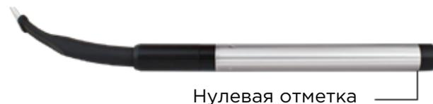
Датчик температуры расположен в наконечнике из нержавеющей стали, однако корпус зонда служит проводником тепла, поэтому наивысшая точность достигается при полном погружении зонда в воду. Конструкция разъема зонда с уплотнительным кольцом позволяет легко заменить его в случае необходимости.
