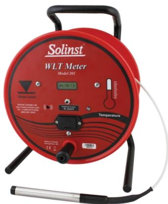
Уровнемер - термометр **Модель 201** предназначен для точного измерения уровня воды в скважинах, а также профилирования температуры в скважинах, колодцах и открытой воде.
