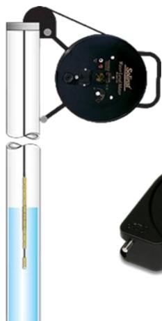
Обеспечивает повторяемость измерений, направляет ленту ближе к центру скважины и предохраняет от истирания и повреждений на краях обсадных труб. Применяется для крепления рулетки на обсадку - "свободные руки" (входит в комплект оборудования)
