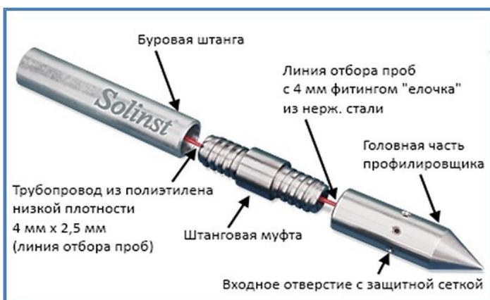
Профилировщик изготовлен из нержавеющей стали, имеет диаметр 1.75" (44,5 мм). Входные отверстия расположены по окружности профилировщика. Входные отверстия ведут к выпускному штуцеру для присоединения 4 мм полиэтиленовой или тефлоновой линии отбора проб.
