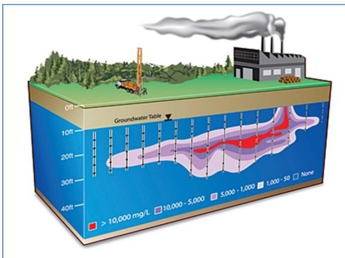
Забивной профилировщик Solinst предназначен для получения образцов грунтовых вод из нескольких горизонтов за одну проходку. Инструмент позволяет значительно сократить затраты на строительство скважин и сроки выполнения инженерных изысканий.
