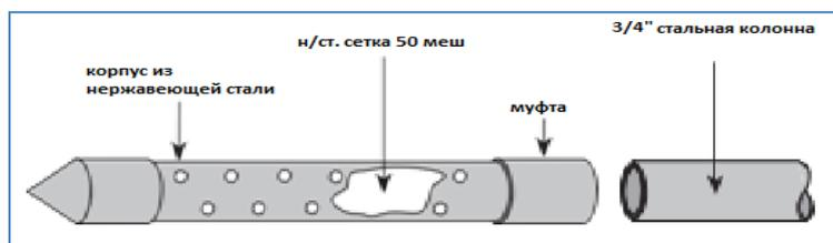
Пьезометр Модель 615 разработан для оперативного мониторинга грунтовых вод в подходящих условиях.
