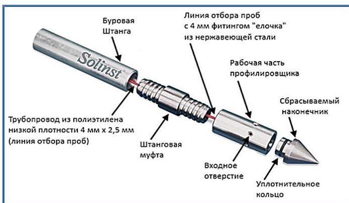
При необходимости тампонирования скважины после взятия образцов, используют профилировщик Модель 660 AW со сбрасываемым наконечником, который отсоединяется от Профилировщика путем подачи под давлением цементного раствора.
