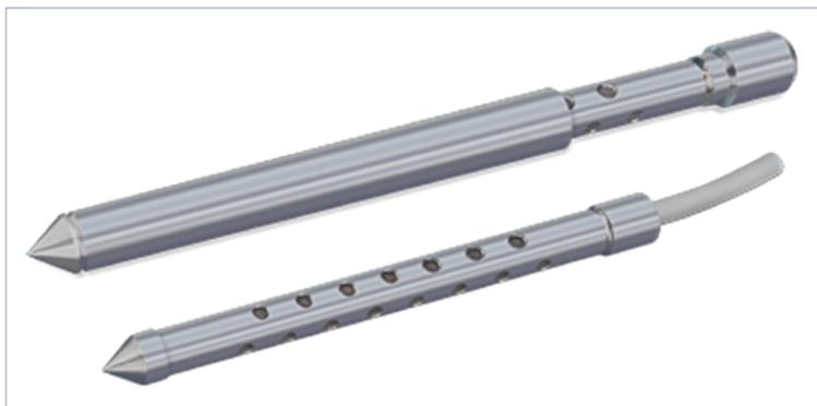
Забивной пьезометр Solinst Модель 615 предназначен для обустройства наблюдательных скважин по технологии **Direct push** с целью обеспечения фильтруемой точки входа подземных вод.
