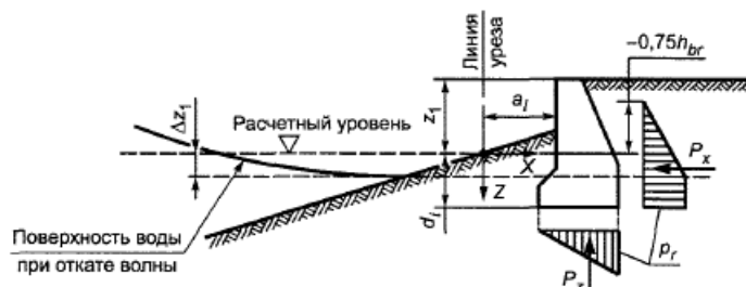
Рисунок 11 - Эпюры волнового давления на вертикальную волнозащитную стену при откате волны
